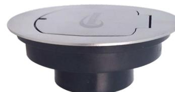
Das Wand- oder Bodenventil wurde speziell nach den Anforderungen der Reinraumtechnik entwickelt. Das Ventilgehäuse ist antistatisch und besteht aus vorgespanntem Polypropylen. Die sichtbaren Flächen des Ventils bestehen aus gebürstetem Edelstahl.
